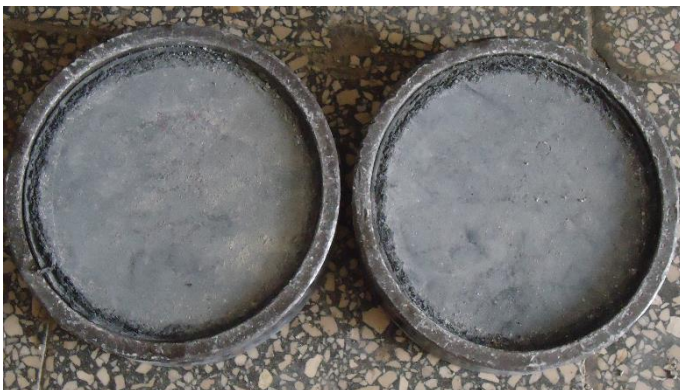
Figura 15. Anillos de aceros para la realización de la compresión.
