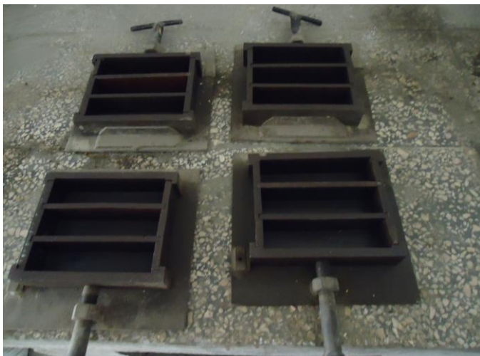
Figura 8. Moldes para la confección de las probetas de mortero.
