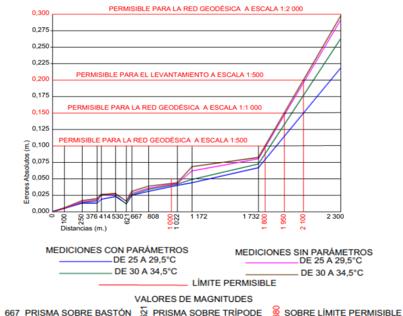
Fig. 3.4. Representación de los resultados obtenidos en la aplicación Medir y Registrar, para la determinación de coordenadas de un punto, desde puntos geodésicos con coordenadas conocidas.
