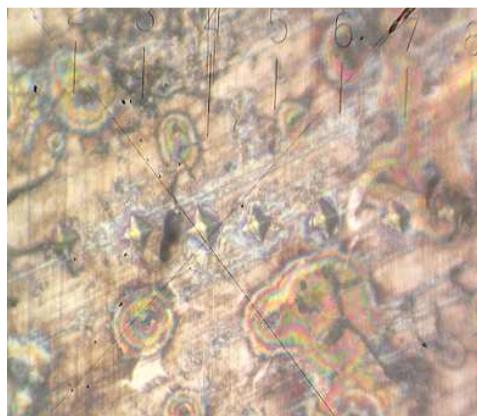
Figura 3.7. Microindentación con TT.
