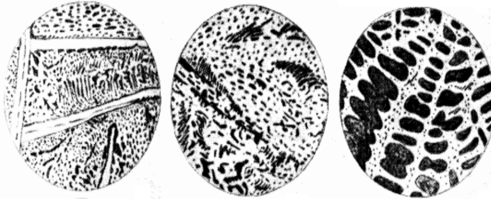
Figura 1.5. Estructuras de la fundición blanca. Fuente: Rojas et al. (2000).
