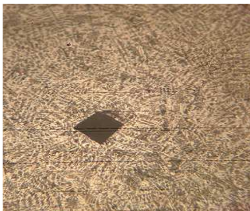
Figura 3.6. Microindentación sin TT.
