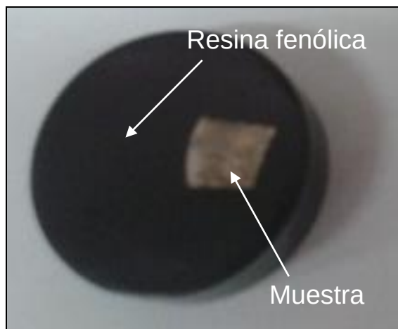
Figura 2.4. Encapsulado de las muestras para el análisis metalográfico.
