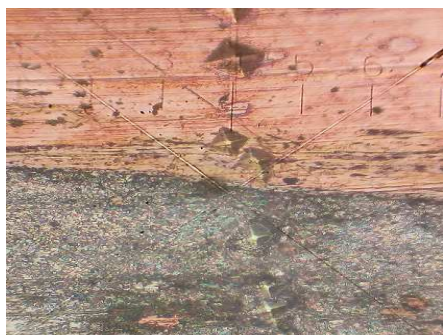
Figura 2.5. Medición de durezas en las diferentes zonas.
