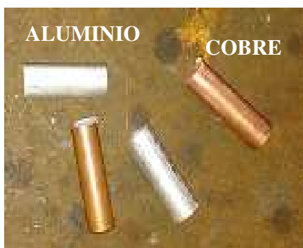
Figura 2.5. Muestras para el proceso de soldadura.
