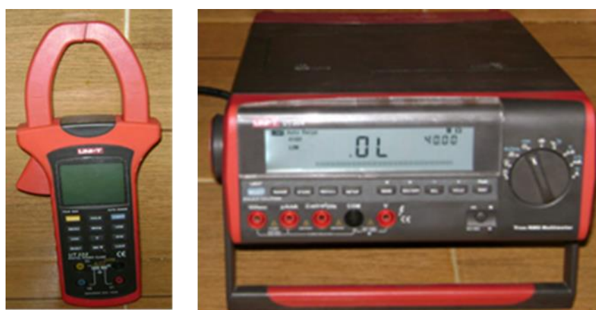
Fig. 2.18 Amperímetro de gancho UT-232 y b) Multímetro digital de mesa UT-804
