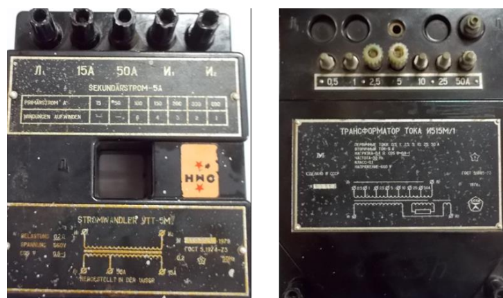
Fig. 2.16 Transformadores de medición.
