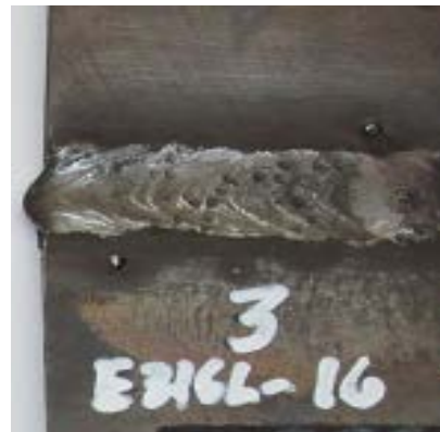
Figura 2.3a. Soldadura con UTP 65. Figura 2.3b. Soldadura con E 316 L-16.
