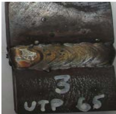
Figura 2.3a. Soldadura con UTP 65. Figura 2.3b. Soldadura con E 316 L-16.
