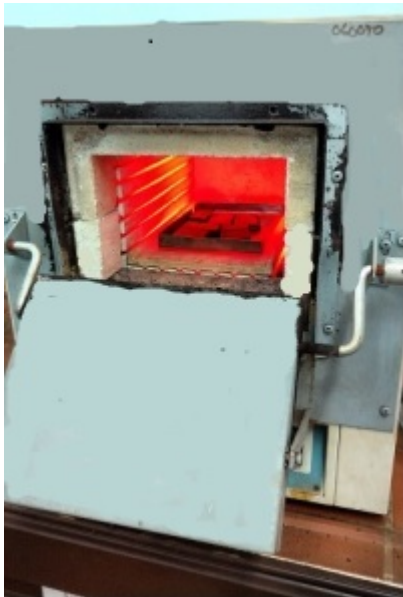
Figura 2.7. Horno de mufla (TT de normalizado).
