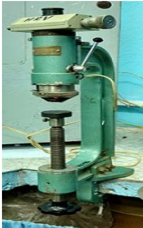
Figura 2.5. Microscopio utilizado para el ensayo de dureza Vickers.
