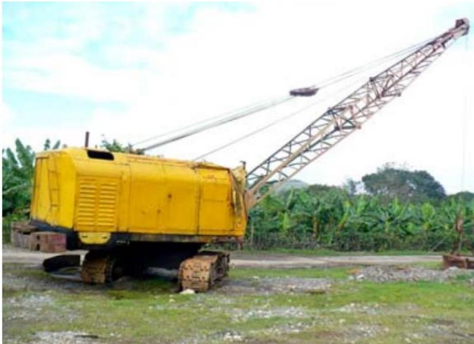
Figura 3. Dragalina que realiza la extracción de material
