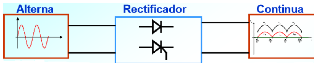
Figura 1.6 Esquema del convertidor de CA a CC.
