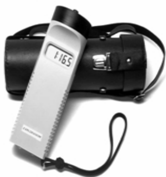
Figura 4. Equipo del análisis de susceptibilidad magnética.
