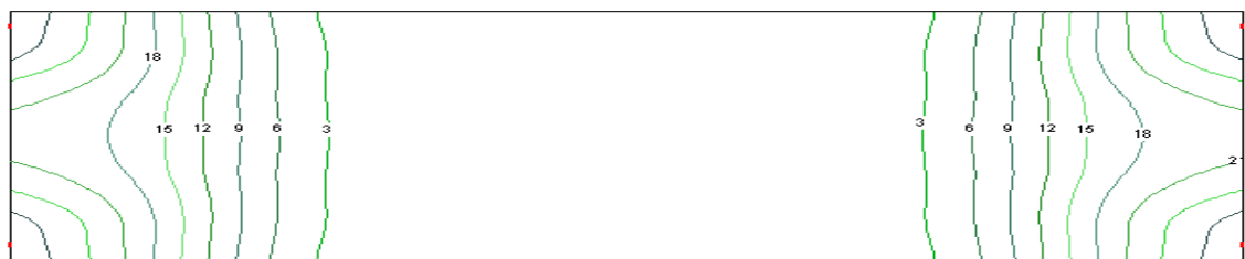
Figura No. 2.11. Diagrama isolux del tramo escogido de la calzada.
