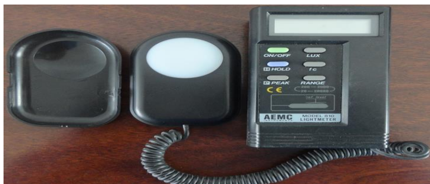
Figura No. 2.6. Luxómetro AEMC-810
