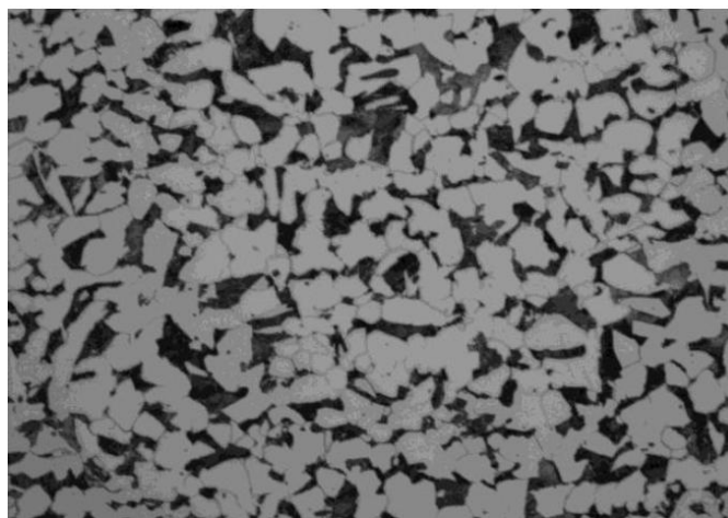
Figura 3.6. Microestructura del Acero API 5L (tubería de 50,8 mm) a 200X
