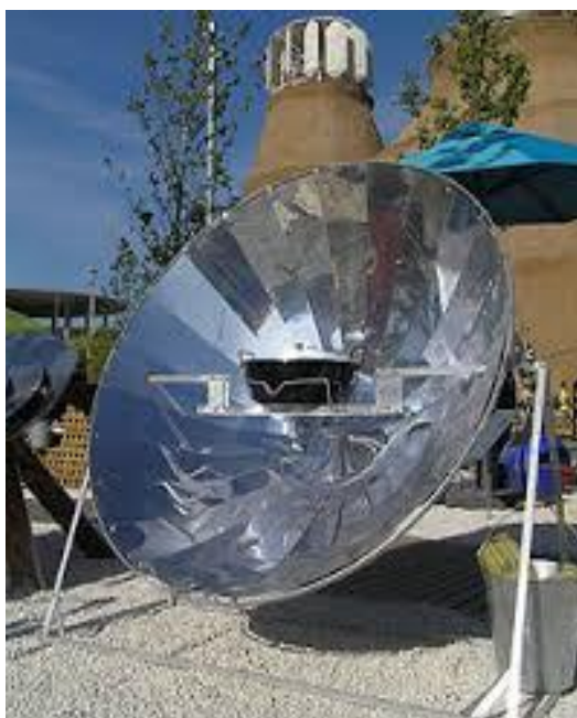
Figura 16. Cocina de concentración de foco profundo en su forma de utilización
