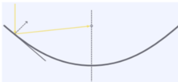
Figura 12. Incidencia de los rayos sobre el foco de la parábola
