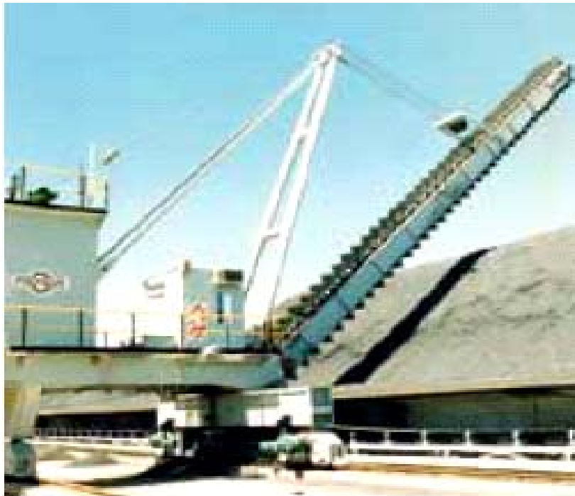
Figura 1– Máquina rascadora que actúa lateralmente.
