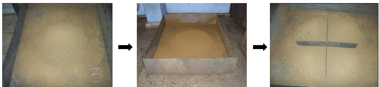
Figura 2. Método de cuarteo para la preparación de la muestra.
