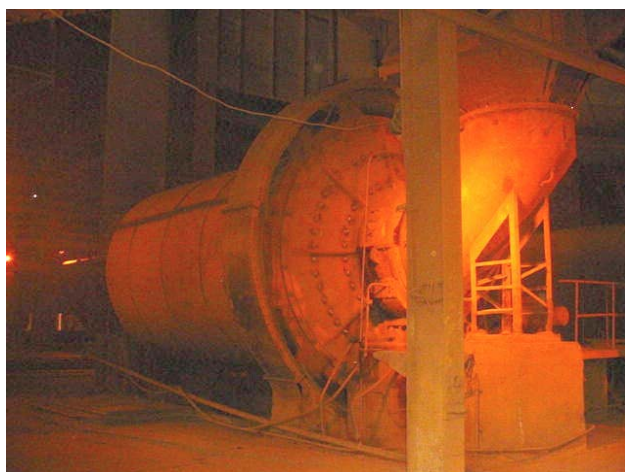
Fig. No.8: Representación del molino de bolas con barrido por aire
