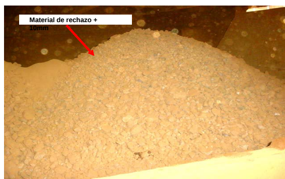
Fig. No.10 Depósito material rechazado
