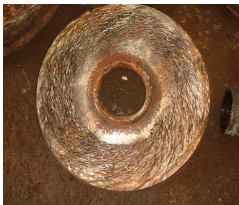
Fig. No. 14: Vista de un elemento deteriorado de las bombas Warman (Plato)
