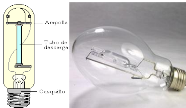
Figura 1.8 Componentes y lámpara de vapor de sodio a alta presión
