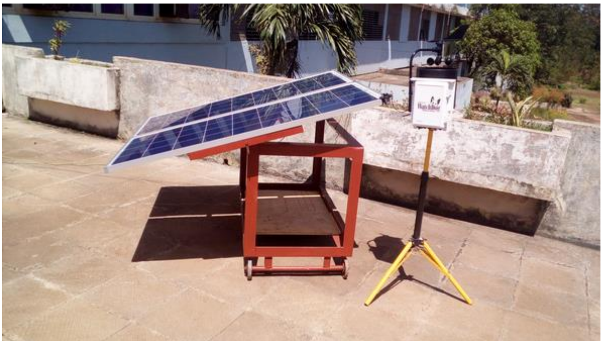
Figura 2.1. Paneles fotovoltaicos y la estación meteorológica ubicados en el 2do piso del Docente #2 del ISMMM.
