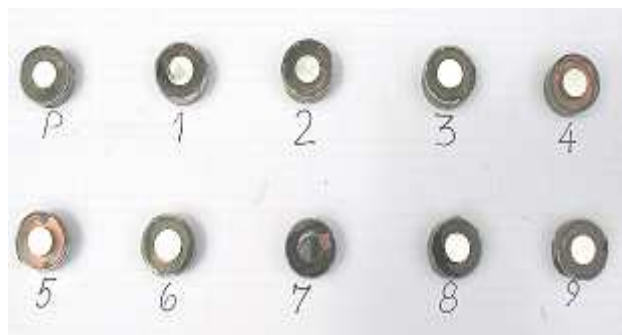
Figura 2.7. Montaje de la muestra empleando resina.
