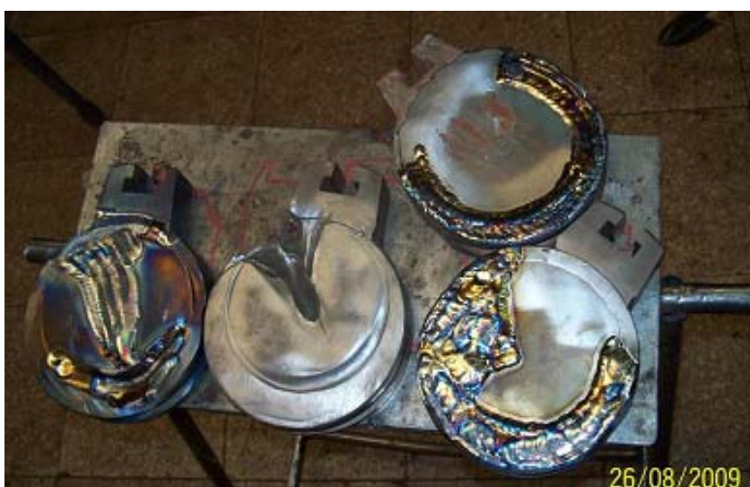
Cuña recuperada por soldadura
