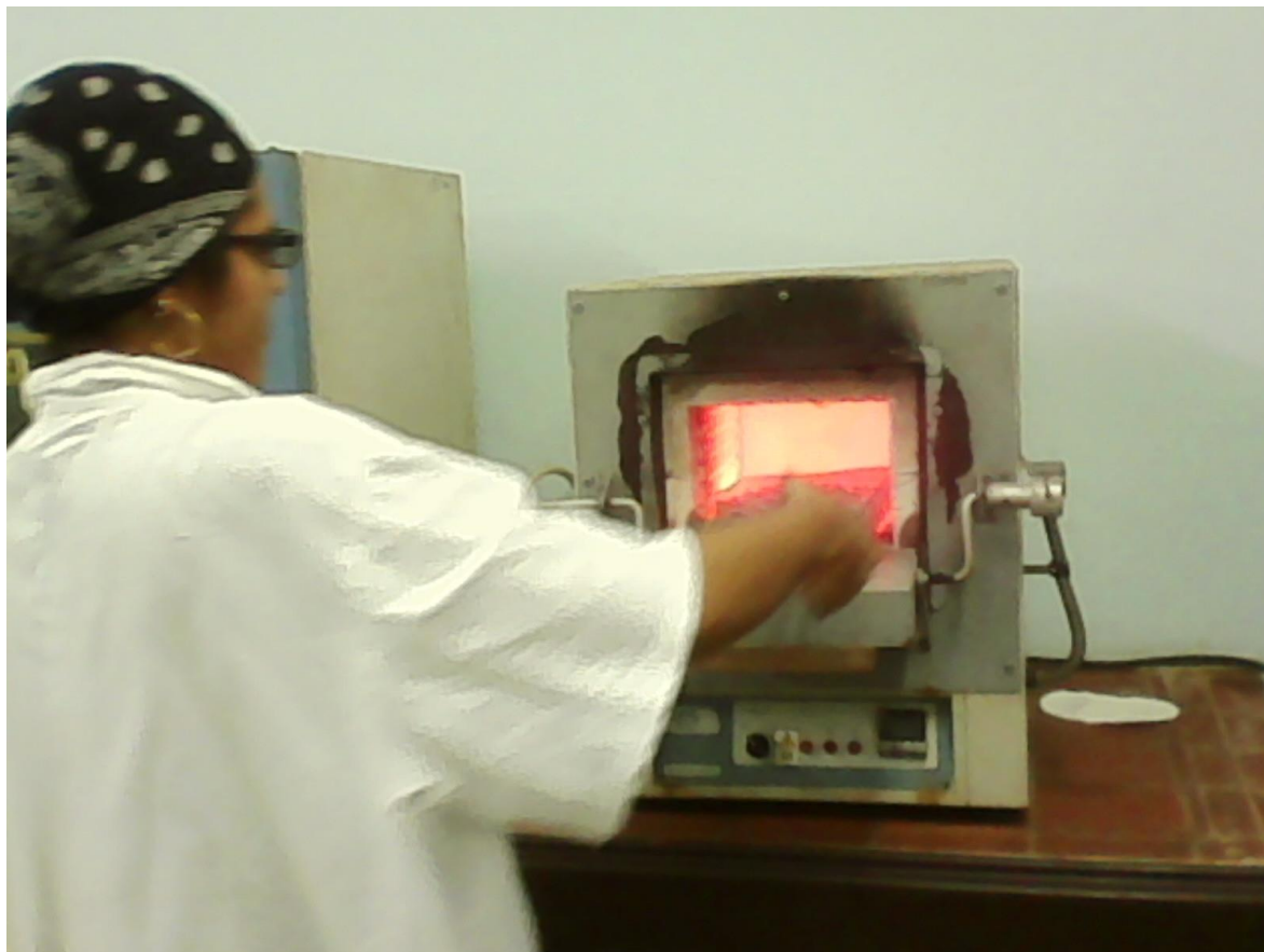
Figura 2.3. Horno eléctrico J.P Selecta 2000-367
