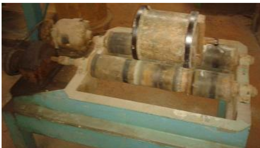
Figura 2.5. Molino de bolas empelado para preparación de la arcilla calcinada
