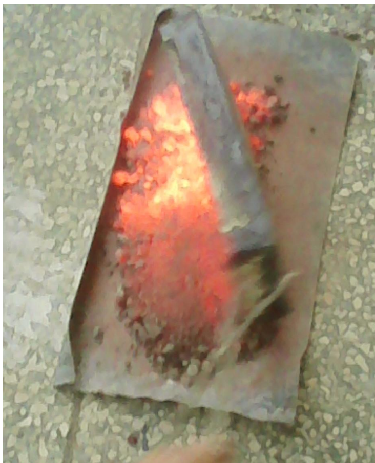
Figura 2.4. Material calcinado esparcido en una bandeja de metal
