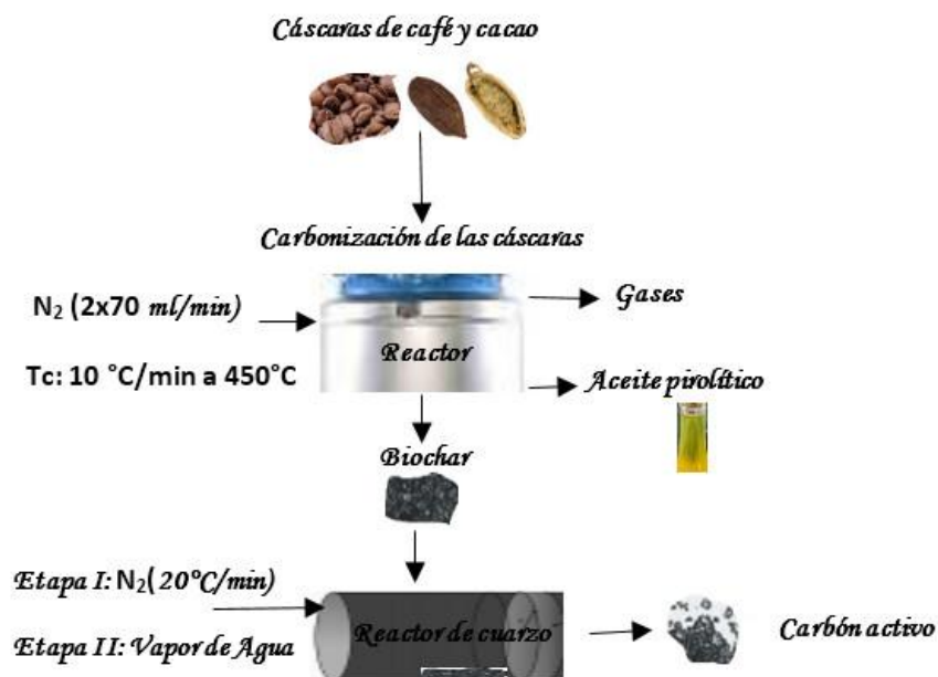
Figura 2.7 Diagrama de obtención del carbón activo fabricado en la investigación
