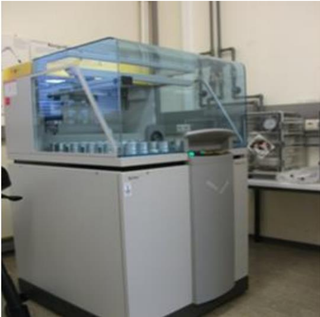
Figura 2.5 Equipo de fluorescencia de rayos x,Axios
