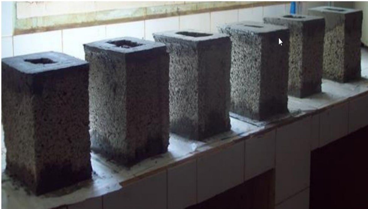
Figura 2.8 Recubrimiento de los bordes del bloque con una capa de cemento P-35
