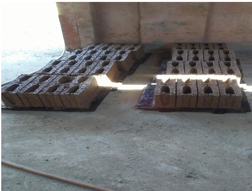
Figura 2.7 Producción de los bloques huecos de hormigón.
