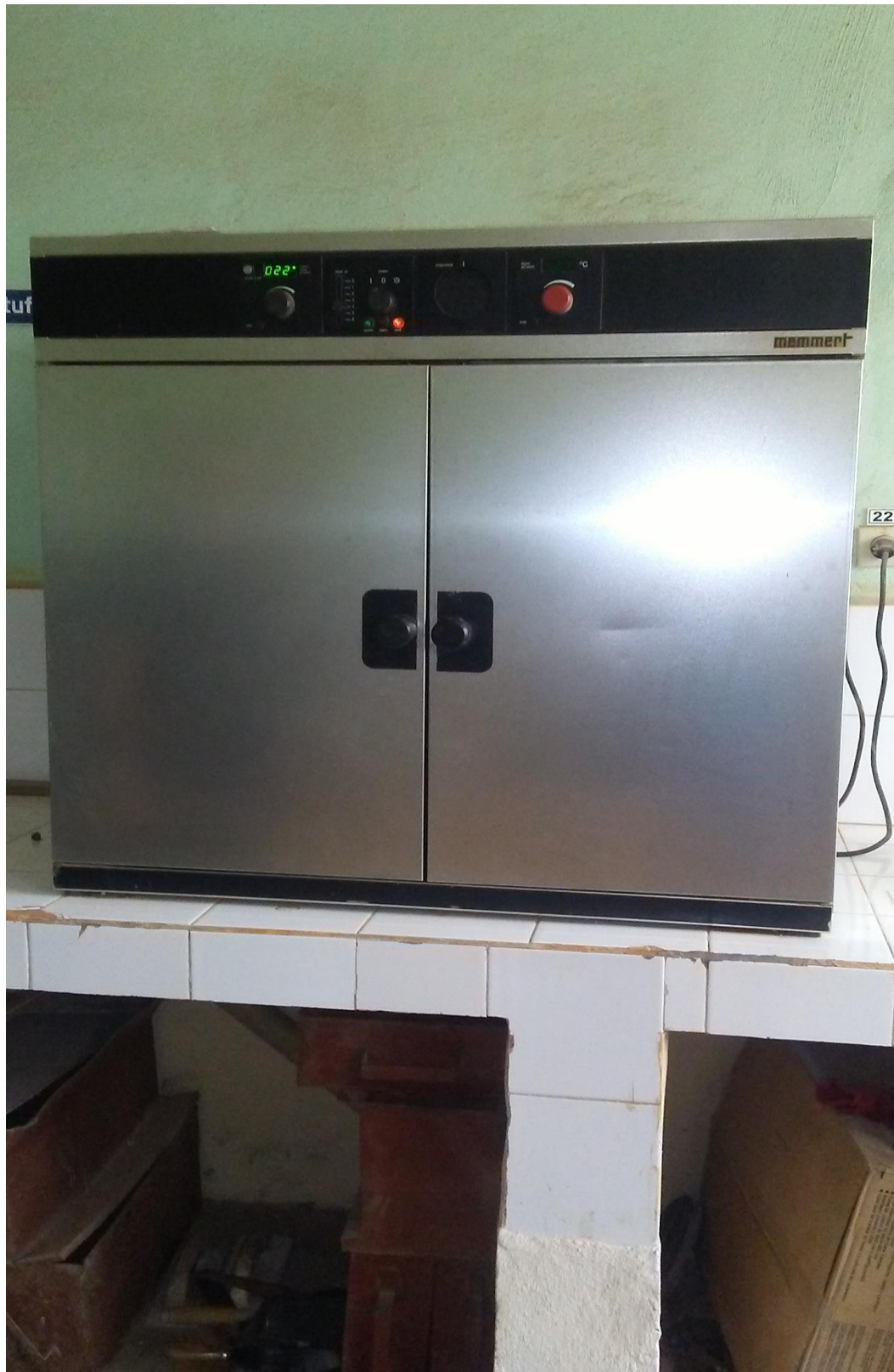
Figura 2.9 Estufa donde permanecieron los bloques durante 24 horas
