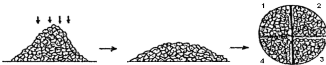
Figura 6 Representación esquemática del método del cono y anillo.
