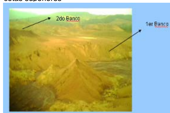
Fig 6: Formas Correctas de comenzar una escombrera de abajo hacia arriba
