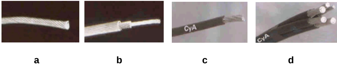
Figura 1.2 Conductores a) Aluminio puro o aleación de aluminio desnudo, b) Aluminio puro o aleación de aluminio con alma de acero, c) Aluminio puro o aleación de aluminio aislado con PVC o XLPE, d) Pre-ensamblados de aluminio aislados con XLPE.
