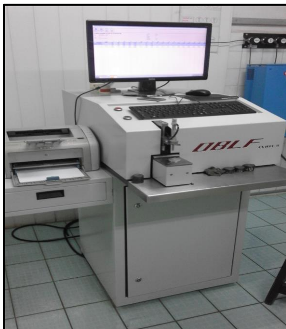
Figura 9. Espectrómetro de masa empleado para la caracterización química del metal obtenido en las pruebas experimentales.
