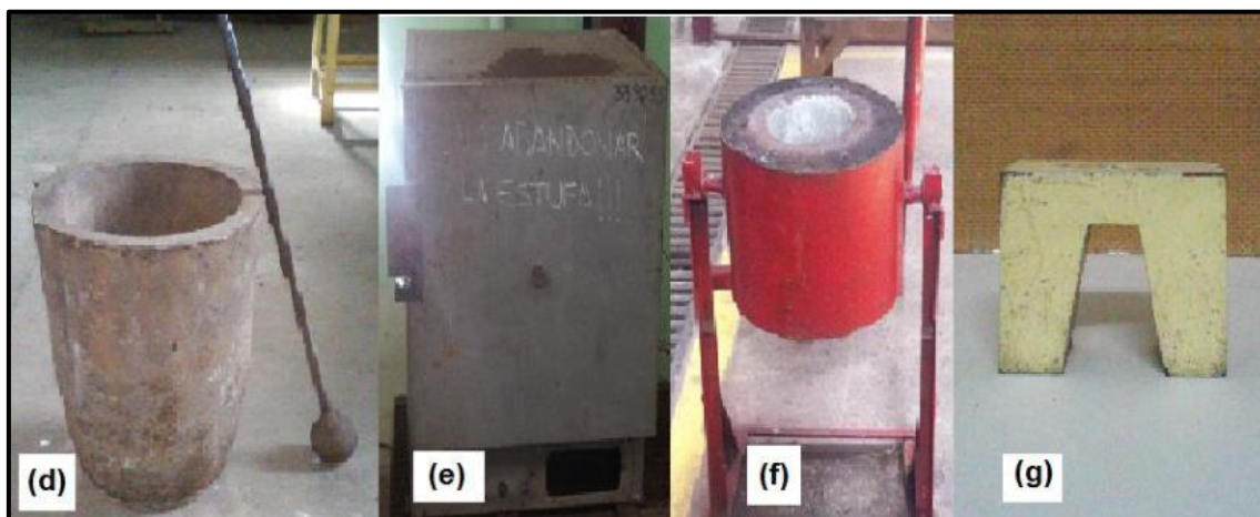
Figura 6. Equipamiento empleado en las pruebas de fusión-reductora Mortero manual (d), Estufa (e), Crisol de grafito (f), Imán permanente (g).
