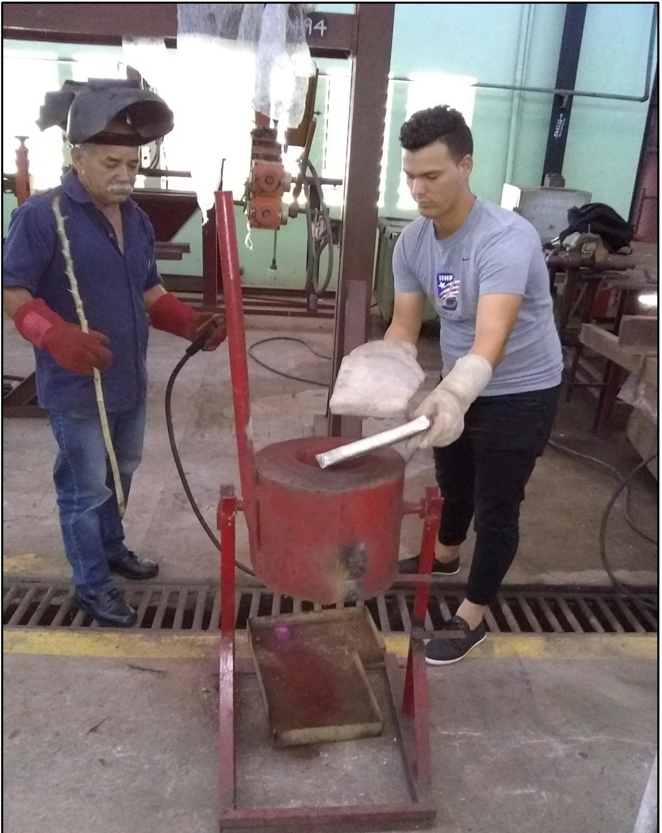
Anexo 6. Proceso de carga de los materiales al horno eléctrico en el CIS.
