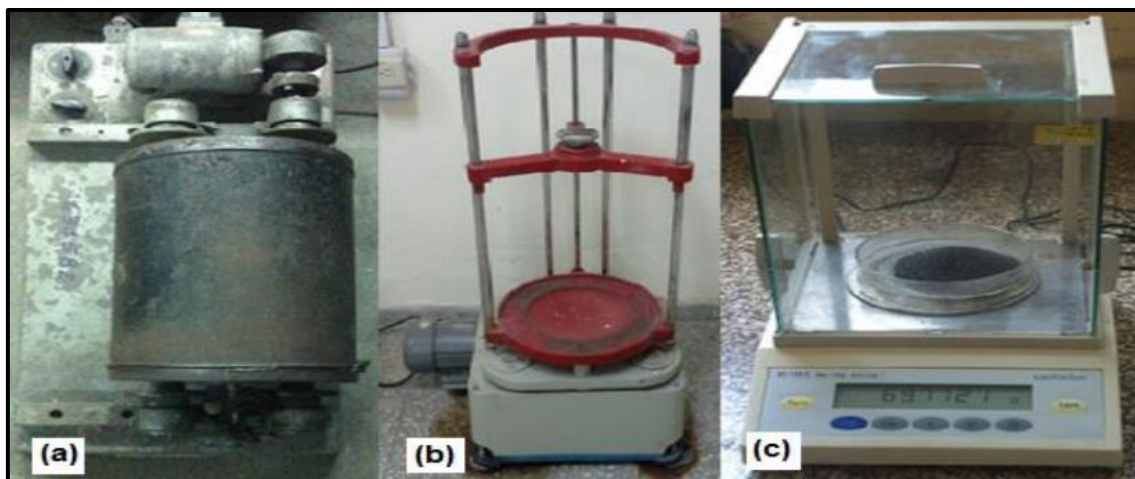
Figura 5. Equipamiento empleado en las pruebas de fusión-reductora Mezcladora tipo tambor (a), tamizadora (b) y Balanza Técnica (c)
