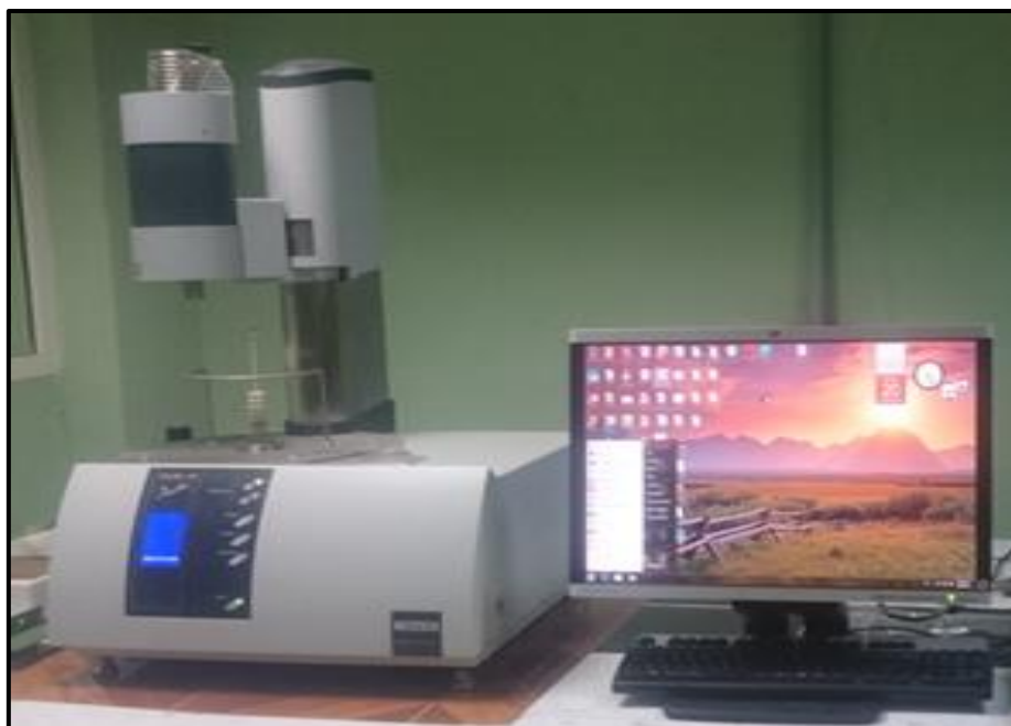
Figura 4. Equipo de análisis térmico, de la firma alemana NETZSCH, modelo STA 449 F3.
