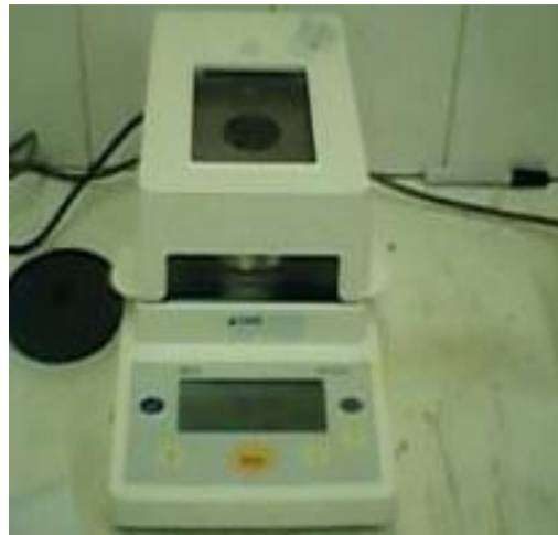
Figura 3. Viscosímetro rotacional de cilindros concéntricos RHEOTEST 2 y analizador de humedad RAD WAG.
