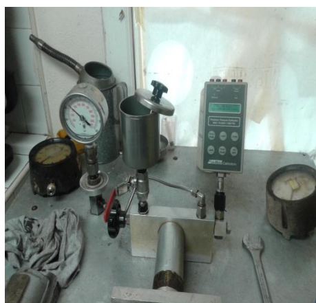
Figura 2. Calibración de los manómetros.
