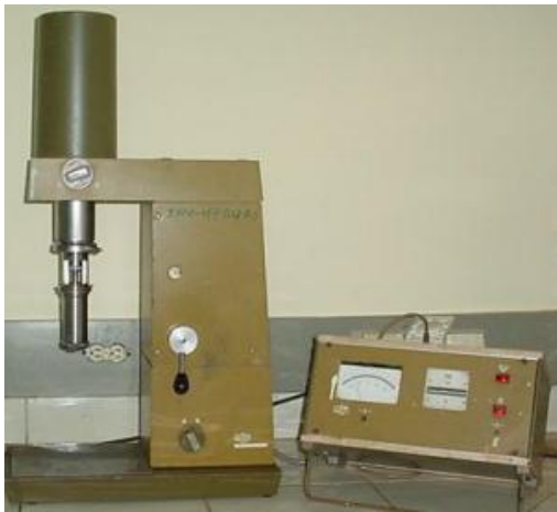
Figura 3. Viscosímetro rotacional de cilindros concéntricos RHEOTEST 2 y analizador de humedad RAD WAG.
