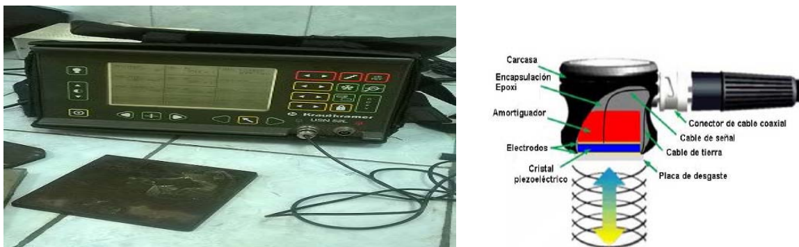
Figura 2.6. Equipo de ultrasonido y esquema del palpador ultrasónico empleados.
