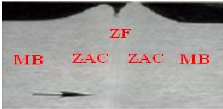
Figura 1.3. Metalografía de unión soldada a tope por fricción. Fuente: UTN (2014).
