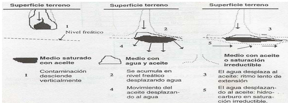
FIGURA 3.1 Etapas de la penetración y mezcla de hidrocarburo con las aguas subterráneas.
