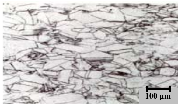
Figura3.- Probeta de acero Hadfield austenizada y deformada por cargas de impacto.
