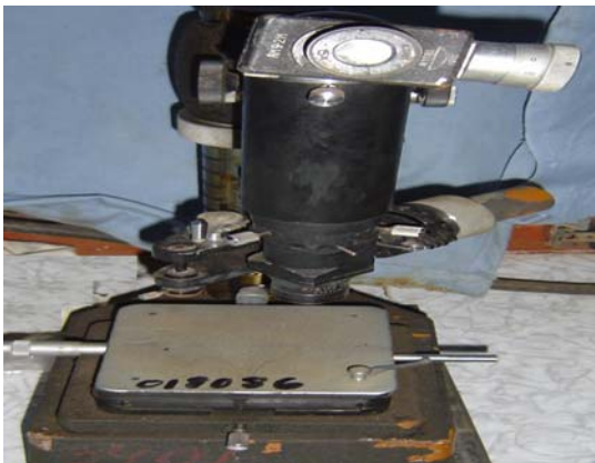
FIGURA 4.2 Microscopio utilizado para el ensayo de microdureza.
