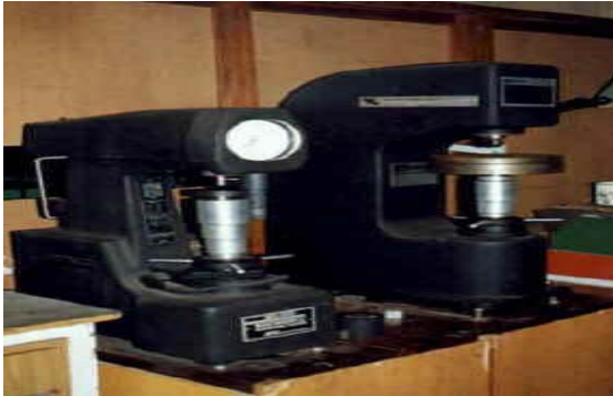
FIGURA 4.1 Durómetro Brinell (Laboratorio de Ciencia de los Materiales del ISMM Moa.)
