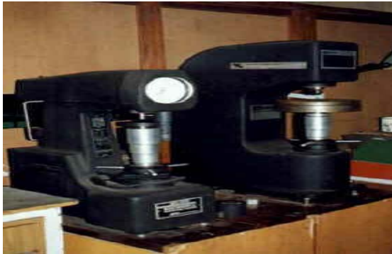
Figura 2.5. Durómetro Brinell (Laboratorio de Ciencia de los Materiales del ISMM Moa.)
