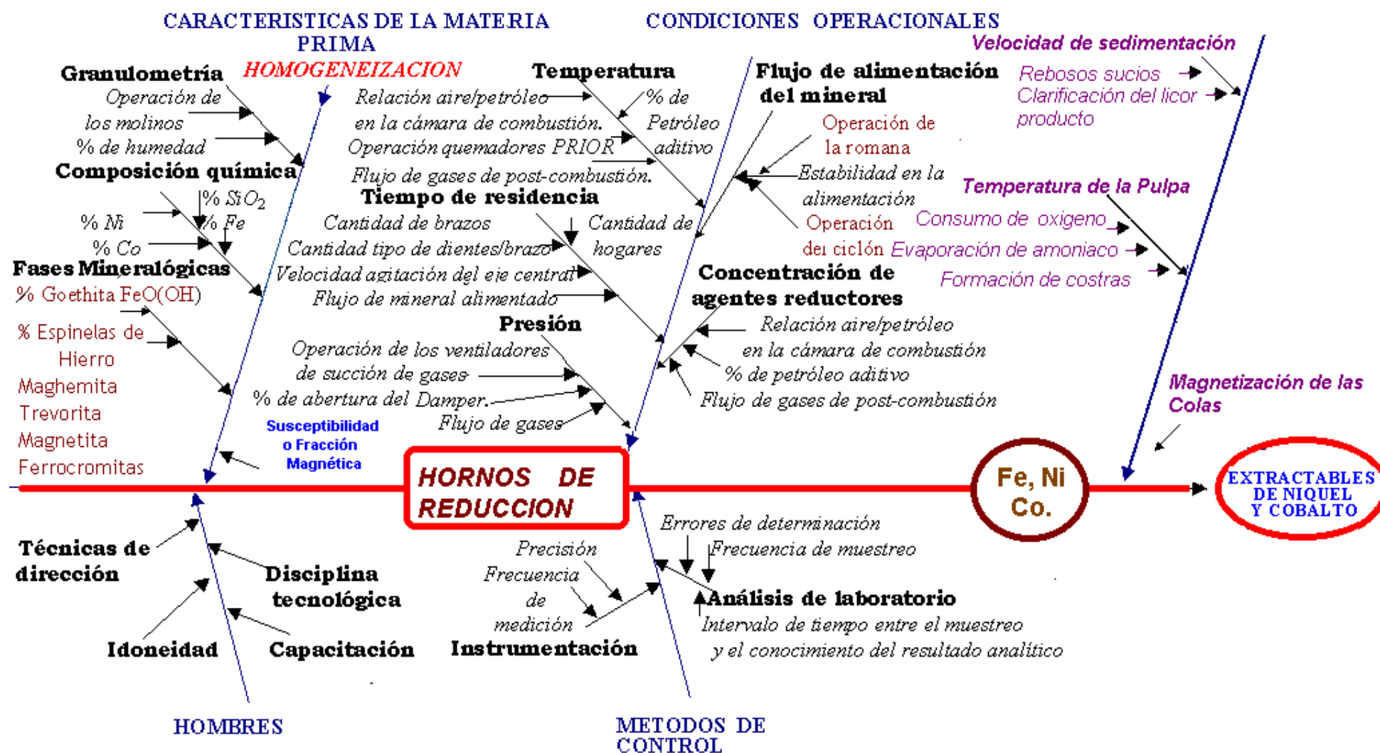
Fig. #1.2. Diagrama de Ishikawa. Factores que influyen en el proceso de reducción y la extracción de níquel y cobalto.
