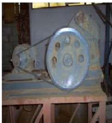
Foto 1. Trituradora de mandíbula 320 x 165 mm
