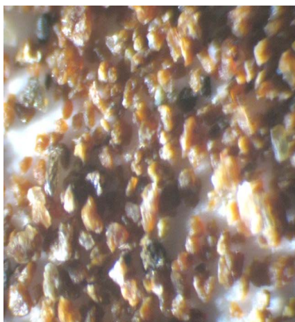
Foto 7. Fracción magnética Condición de trabajo: 1 A Aumento: 2. 5 x 10
