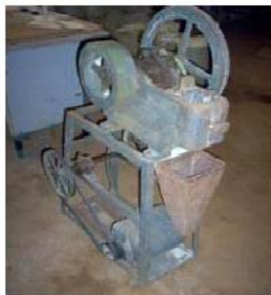
Foto 2. Trituradora de mandíbula 150 x 75 mm
