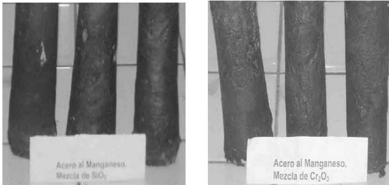
**Figura No 7. Probetas fundidas de acero al manganeso.**
