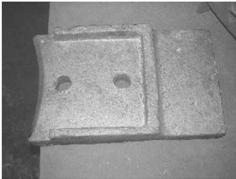
**Figura No 8. Paleta D fundida de acero al manganeso.**
