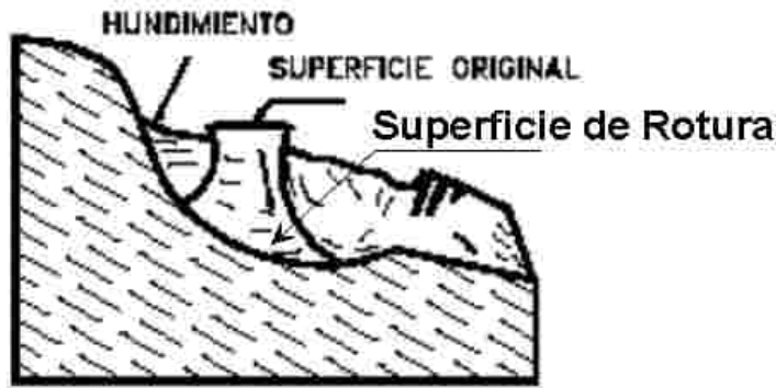
Fig.II.2.6 Esquema de un deslizamiento rotacional típico
