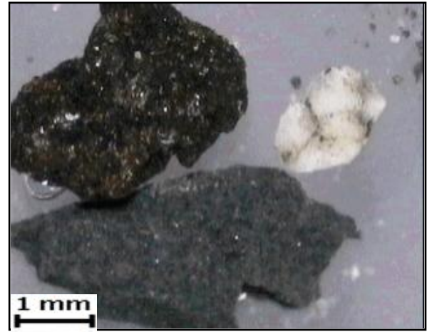
Figura 31: Calizas fracturadas y argilitas del Titoniano.
