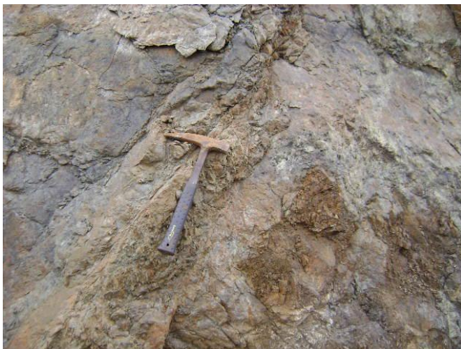
Figura 4.- Serpentinita brechosa media. Espejo de fricción en pequeña falla.
