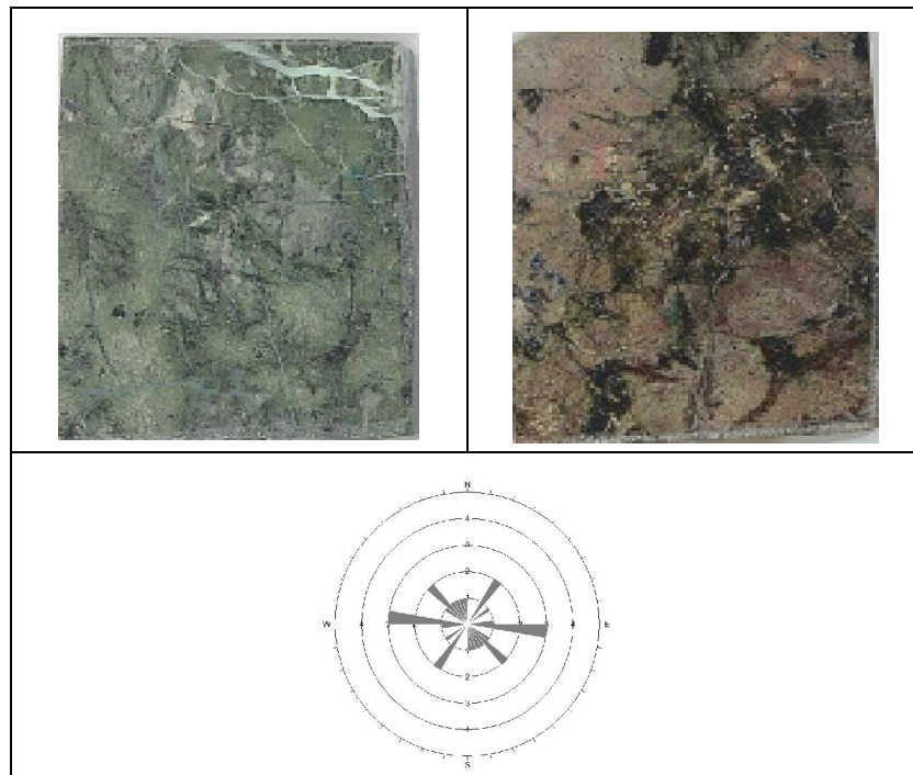
Figura 3.36. Secciones pulidas y diagrama de rosetas del microagrietamiento en el bloque Cabaña Norte.
