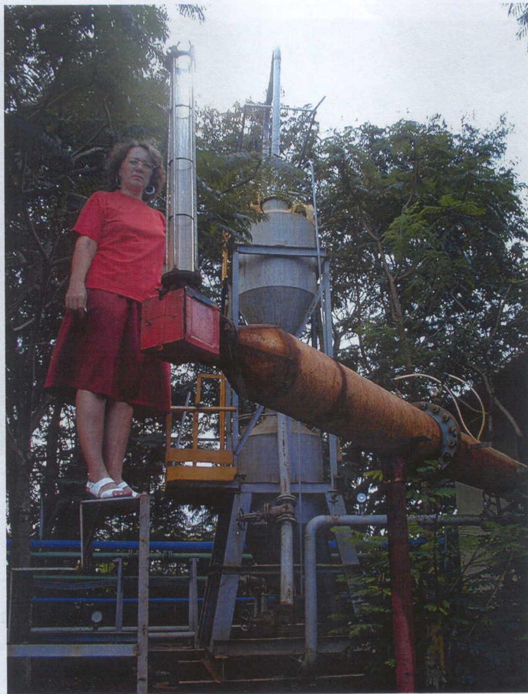
Foto 1. Instalación experimental para la determinación de la velocidad de flotación de las partículas.
