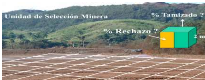
Figura 17 Esquema de unidad de selección minera en el modelo de bloque de la PRN
