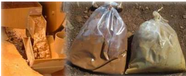
Foto 4. Muestras de pulpa de material limonítico, fracción menor que 0,85 mm
