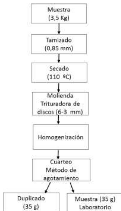
Figura 6. Esquema resumido de preparación de muestras utilizado en la PRN
