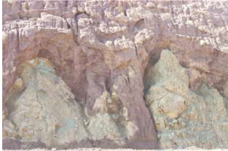
Foto 1. Ejemplo de perfil laterítico con fragmentos de rocas serpentinizadas
